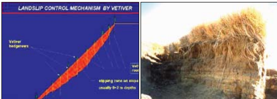
Figura 1: Izquierda: Principios de estabilización de pendientes con el vetiver; derecha: Las raíces de Vetiver refuerzan esta pared de dique protegiéndola de ser arrastrada por las crecidas e inundaciones.
